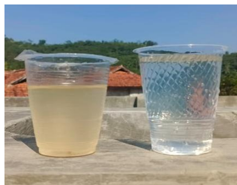
Gambar 8. Kondisi Air Sebelum (kiri) dan Sesudah (kanan) Disaring pada Penyaring Air Sistem Vortex
