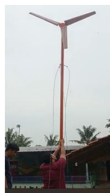
Gambar 4. Kincir Angin Biokomposit berbahan Enceng Gondok untuk PLTA Skala Kecil
